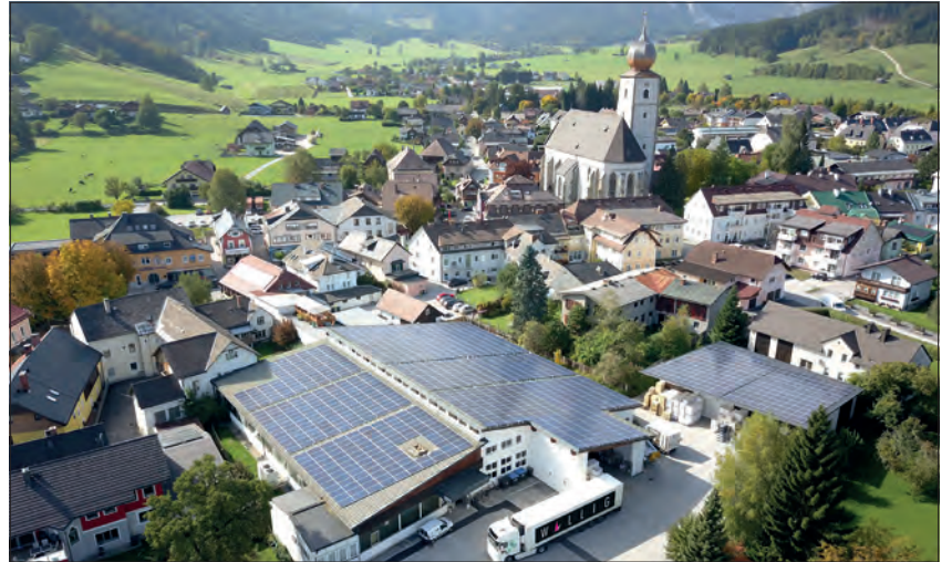
Gesamtblick auf die Photovoltaikanlagen am Dach der Produktionsgebäude der Druckerei Wallig in Gröbming. Rund 1600 Module erzeugen im Jahr etwa 400.000 Kilowattstunden Ökostrom.
